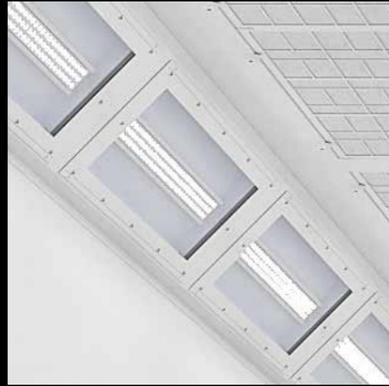
Die Anlage verfügt über eine vollständige Öffnung an der Vorderseite, eine Innenbeleuchtung mit drei Reihen an Deckenlampen, um Reflexe und Schatten zu vermeiden, über ein Plenum für eine konstante Luftzufuhr unter jeder Bedingung sowie über ein vollständig automatisches Bedienpaneel zur Planung jeder Bearbeitungsphase und der Temperatur. Die perfekte Kombination aus diesen Details ermöglicht ein schnelles Erreichen herausragender Ergebnisse jeder Größe.
